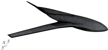
图 5 HWB-0 半模表面网格
